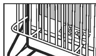
パイロットバーナー (使用中は燃焼しています)
